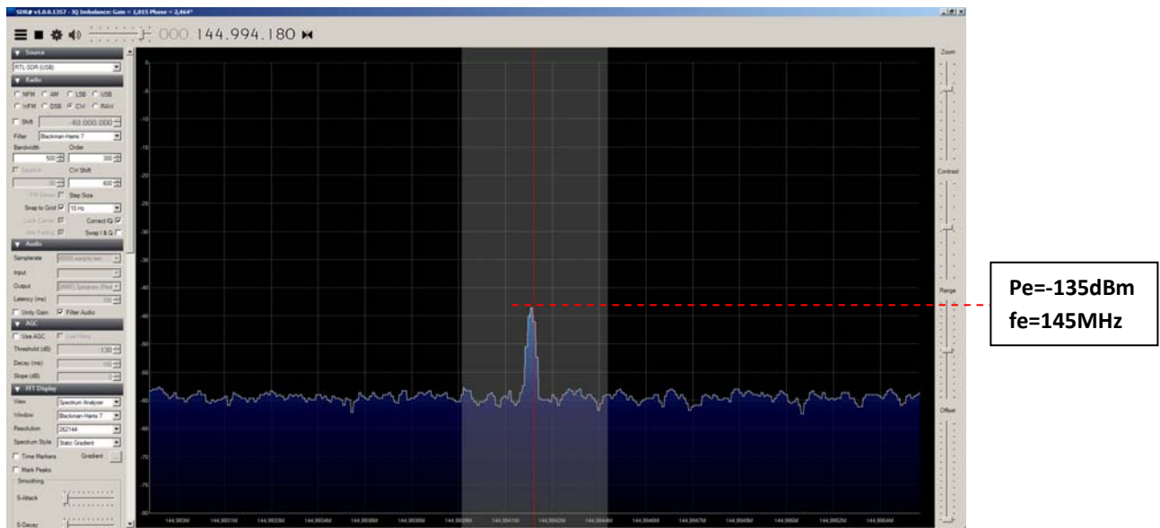
Bild 2: Signalpegel P_e = -135\text{dBm} für ein akustisches (S+N)/N = 3dB
