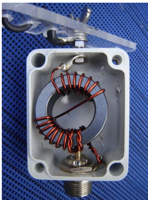
Breitband-Ringkernübertrager für 80, 40, 20, 15 und 10m
