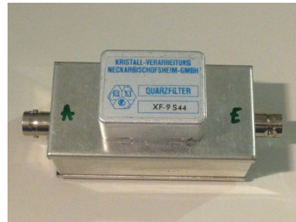
Bild 9: Verwendetes 9MHz Quarzfilter mit 50Ohm Anpassung über MCL-Übertrager
