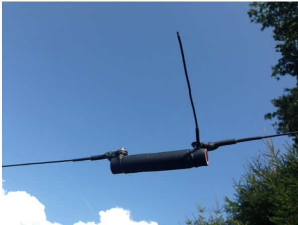
Bild 6: Stück Draht (Stub) am Ausgang der 1. Verlängerungsspule
