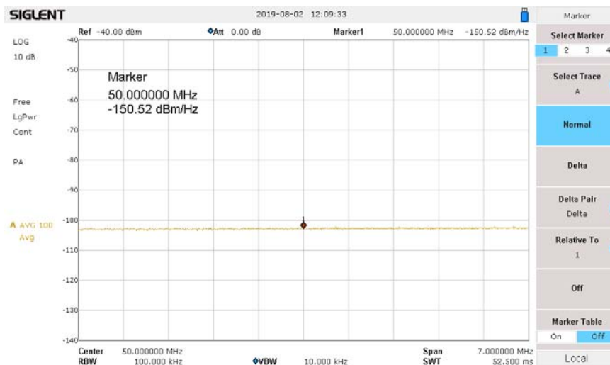
Bild 5: Messung des Rauschens mit Amplifier: Noise -150,5dBm/Hz
