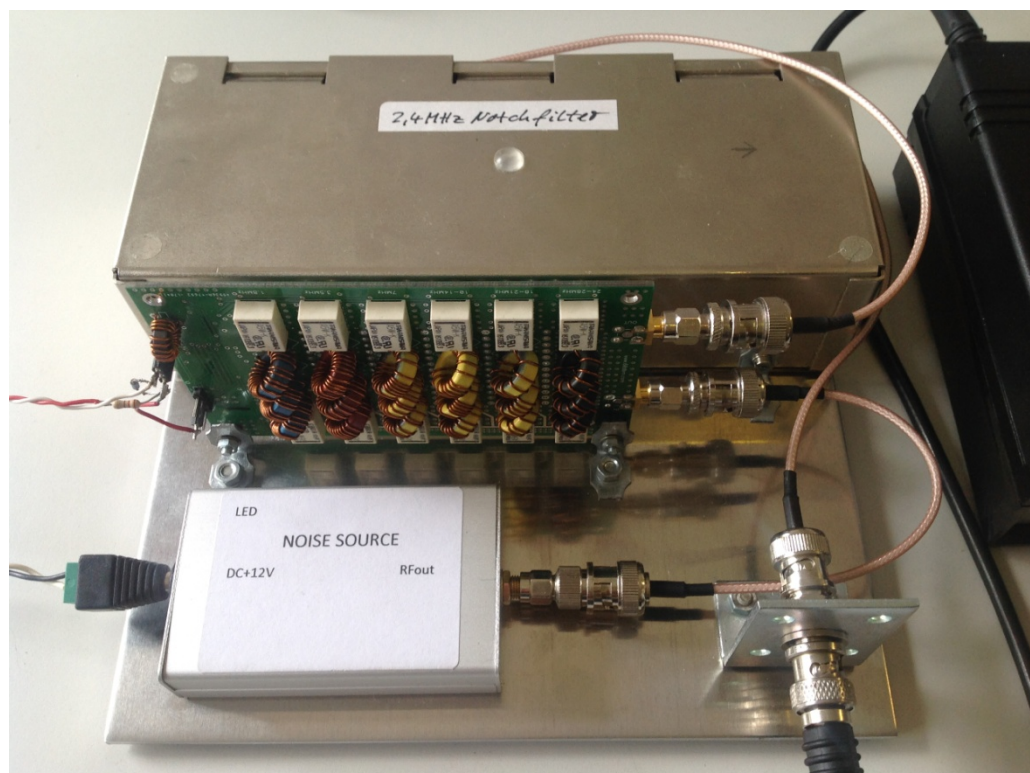
Bild 3: Messaufbau, mit Rauschgenerator, schaltbare TP-Filter und 2,4MHz Notch-Filter
