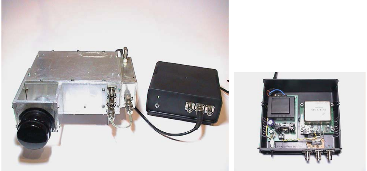
Bild 14: VFO mit seitlich angeflanschter DAFC und externem, optionalem OCXO
