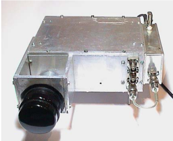
Bild 6: 3-Band-VFO (40-70 MHz) mit Drehkondensator-Abstimmung und seitlich angeflanschter DAFC
